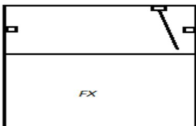
CONJUNTO EM VIDRO CRISTAL TEMPERADO 8MM INCOLOR JATEADO, COMPOSTO POR UMA JANELA TIPO BASCULANTE E UM VIDRO FIXO, INSTALADO COM FERRAGENS PARA BASCULANTE EM FERRAGEM TIPO AÇO INOXIDÁVEL OU SIMILAR, OU EQUIVALENTE OU DE MELHOR QUALIDADE; EXCETO TIPOS PLÁSTICOS E SIMILARES, PERFÍS EM ALUMÍNIO, BORRACHA E SILICONE PARA VEDAÇÃO. LARGURA DE 811MM X 1555MM DE ALTURA. TOTAL DE ÁREA = 1,26m<sup>2</sup>.
