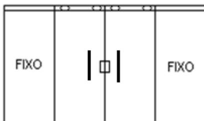
CONJUNTO EM VIDRO CRISTAL TEMPERADO 10MM INCOLOR JATEADO, COMPOSTO POR DOIS VIDROS FIXOS E DOIS VIDROS DE CORRER, INSTALADO COM TRILHO, CAPA, GUIA, ROLDANAS COM ROLAMENTO, FECHADURA CENTRAL E PUXADOR H EM FERRAGEM TIPO AÇO INOXIDÁVEL, OU SIMILAR, EQUIVALENTE OU DE MELHOR QUALIDADE; EXCETO TIPOS PLÁSTICOS E SIMILARES, PERFÍS TIPO “U” EM ALUMÍNIO, BORRACHA E SILICONE PARA VEDAÇÃO. LARGURA DE 3970MM X 2865MM DE ALTURA. TOTAL DE ÁREA = 11,35m<sup>2</sup>.
