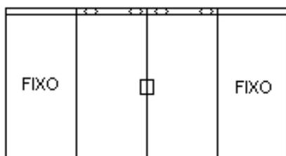
2 CONJUNTOS EM VIDRO CRISTAL TEMPERADO 8MM INCOLOR , COMPOSTO POR DOIS VIDROS FIXOS E DOIS VIDROS DE CORRER, INSTALADO COM TRILHO, CAPA, GUIA, ROLDANAS COM ROLAMENTO, FECHADURA CENTRAL E PUXADOR H EM FERRAGEM TIPO AÇO INOXIDÁVEL OU SIMILAR, OU EQUIVALENTE OU DE MELHOR QUALIDADE; EXCETO TIPO PLÁSTICOS E SIMILARES, PERFÍS TIPO “U” EM ALUMÍNIO, BORRACHA E SILICONE PARA VEDAÇÃO. SENDO
