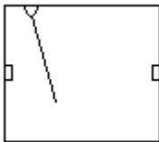
CONJUNTO EM VIDRO CRISTAL TEMPERADO 8MM INCOLOR, COMPOSTO POR UMA JANELA TIPO BASCULANTE, INSTALADO COM FERRAGENS PARA BASCULANTE EM FERRAGEM TIPO AÇO INOXIDÁVEL OU SIMILAR, OU EQUIVALENTE OU DE MELHOR QUALIDADE; EXCETO TIPO PLÁSTICOS E SIMILARES, CANTONEIRA NOS QUATRO LADOS E SILICONE PARA VEDAÇÃO.
