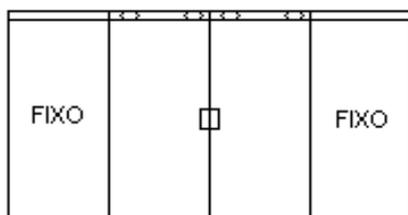
CONJUNTO EM VIDRO CRISTAL TEMPERADO 8MM INCOLOR JATEADO, COMPOSTO POR DOIS VIDROS FIXOS E DOIS VIDROS DE CORRER, INSTALADO COM TRILHO, CAPA, GUIA, ROLDANAS COM ROLAMENTO, FECHADURA CENTRAL E PUXADOR H EM FERRAGEM TIPO AÇO INOXIDÁVEL OU SIMILAR, EQUIVALENTE OU DE MELHOR QUALIDADE; EXCETO TIPO PLÁSTICOS E SIMILARES, PERFÍS TIPO “U” EM ALUMÍNIO, BORRACHA E SILICONE PARA VEDAÇÃO. LARGURA DE 3122MM X
