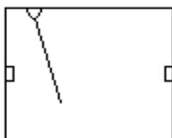
2 CONJUNTOS EM VIDRO CRISTAL TEMPERADO 8MM INCOLOR, COMPOSTO POR UMA JANELA TIPO BASCULANTE, INSTALADO COM FERRAGENS PARA BASCULANTE EM FERRAGEM TIPO AÇO INOXIDÁVEL OU SIMILAR, OU EQUIVALENTE OU DE MELHOR QUALIDADE; EXCETO TIPO PLÁSTICOS E SIMILARES, CANTONEIRA NOS QUATRO LADOS E SILICONE PARA VEDAÇÃO. SENDO JANELA 1 = LARGURA DE 590MM X 797,5MM DE ALTURA; JANELA 2 = LARGURA DE 590MM X 797,5MM DE
