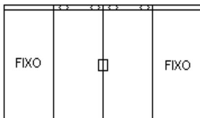
CONJUNTO EM VIDRO CRISTAL TEMPERADO 8MM INCOLOR JATEADO, COMPOSTO POR DOIS VIDROS FIXOS E DOIS VIDROS DE CORRER, INSTALADO COM TRILHO, CAPA, GUIA, ROLDANAS COM ROLAMENTO, FECHADURA CENTRAL E PUXADOR H EM FERRAGEM TIPO AÇO INOXIDÁVEL OU SIMILAR, OU EQUIVALENTE OU DE MELHOR QUALIDADE; EXCETO TIPO PLÁSTICOS E SIMILARES, PERFÍS TIPO "U" EM ALUMÍNIO, BORRACHA E SILICONE PARA VEDAÇÃO. LARGURA DE 3103MM X 1600MM DE ALTURA. TOTAL DE ÁREA =
