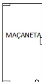
CONJUNTO EM VIDRO CRISTAL TEMPERADO 10MM INCOLOR, COMPOSTO POR UMA PORTA DE GIRO, INSTALADO COM DOBRADIÇAS SUPERIOR E INFERIOR, FECHADURA CENTRAL E PUXADOR H EM FERRAGEM TIPO AÇO INOXIDÁVEL OU SIMILAR, OU EQUIVALENTE OU DE MELHOR QUALIDADE; EXCETO TIPO PLÁSTICOS E SIMILARES, PUXADOR DE MADEIRA E TRINCO DE PISO. LARGURA DE 1013MM X 2100MM DE ALTURA. TOTAL DE ÁREA = 2,13m<sup>2</sup>.
