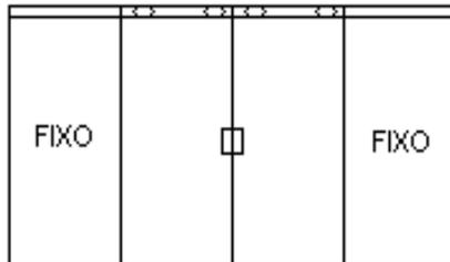
MELHOR QUALIDADE; EXCETO TIPO PLÁSTICOS E SIMILARES, PERFÍS TIPO “U” EM ALUMÍNIO, BORRACHA E SILICONE PARA VEDAÇÃO. LARGURA DE 1460MM X 1220MM DE ALTURA. TOTAL DE ÁREA = 1,78m<sup>2</sup>.
