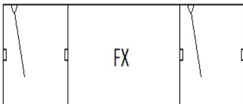
CONJUNTO EM VIDRO CRISTAL TEMPERADO 8MM INCOLOR JATEADO, COMPOSTO POR DUAS JANELAS TIPO BASCULANTE E UM VIDRO FIXO, INSTALADO COM FERRAGENS PARA BASCULANTE EM FERRAGEM TIPO AÇO INOXIDÁVEL OU SIMILAR, OU EQUIVALENTE OU DE MELHOR QUALIDADE; EXCETO TIPO PLÁSTICOS E SIMILARES, PERFÍS EM ALUMÍNIO, BORRACHA E SILICONE PARA VEDAÇÃO. LARGURA DE 3205MM X 987,5MM DE ALTURA. TOTAL DE ÁREA = 3,17m<sup>2</sup>.
