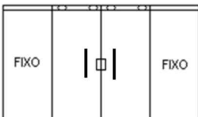
CONJUNTO EM VIDRO CRISTAL TEMPERADO 10MM INCOLOR JATEADO, COMPOSTO POR DOIS VIDROS FIXOS E DOIS VIDROS DE CORRER, INSTALADO COM TRILHO, CAPA, GUIA, ROLDANAS COM ROLAMENTO, FECHADURA CENTRAL E PUXADOR H EM FERRAGEM TIPO AÇO INOXIDÁVEL OU SIMILAR, EXCETO TIPO PLÁSTICOS E SIMILARES, PERFÍS TIPO "U" EM ALUMÍNIO, BORRACHA E SILICONE PARA VEDAÇÃO. LARGURA DE 2400MM X 1425MM DE ALTURA. LARGURA DE 2366MM X 2670MM DE ALTURA. TOTAL DE ÁREA =
