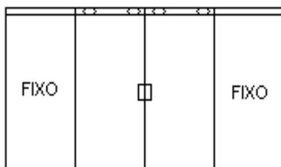
2 CONJUNTOS EM VIDRO CRISTAL TEMPERADO 8MM INCOLOR JATEADO, COMPOSTO POR DOIS VIDROS FIXOS E DOIS VIDROS DE CORRER, INSTALADO COM TRILHO, CAPA, GUIA, ROLDANAS COM ROLAMENTO, FECHADURA CENTRAL E PUXADOR H EM FERRAGEM TIPO AÇO INOXIDÁVEL OU SIMILAR, OU EQUIVALENTE OU DE MELHOR QUALIDADE; EXCETO TIPO PLÁSTICOS E SIMILARES, PERFÍS TIPO "U" EM ALUMÍNIO, BORRACHA E SILICONE PARA VEDAÇÃO. SENDO JANELA 1 = LARGURA DE 2908MM X 1625MM DE ALTURA;
