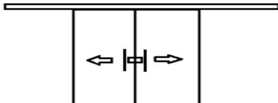
QUALIDADE; EXCETO TIPO PLÁSTICOS E SIMILARES, PERFÍS TIPO “U” EM ALUMÍNIO E SILICONE PARA VEDAÇÃO. LARGURA DE 2540MM X 2500MM DE ALTURA. TOTAL DE ÁREA = 6,35m<sup>2</sup>.
