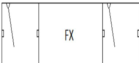
CONJUNTO EM VIDRO CRISTAL TEMPERADO 8MM INCOLOR JATEADO, COMPOSTO POR DUAS JANELAS TIPO BASCULANTE E UM VIDRO FIXO, INSTALADO COM FERRAGENS PARA BASCULANTE EM FERRAGEM TIPO AÇO INOXIDÁVEL OU SIMILAR, OU EQUIVALENTE OU DE MELHOR QUALIDADE; EXCETO TIPO PLÁSTICOS E SIMILARES, PERFÍS EM ALUMÍNIO, BORRACHA E SILICONE PARA VEDAÇÃO. LARGURA DE 1914MM X 997,5MM DE ALTURA. TOTAL DE ÁREA = 1,91m<sup>2</sup>.
